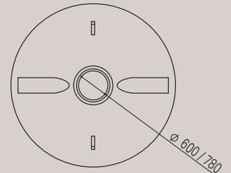
La fosse septique toutes eaux reçoit l'ensemble des eaux usées domestiques (eaux ménagères et eaux vannes), dont elle assure le prétraitement. Elle permet la rétention des matières solides et la liquéfaction des matières organiques contenues dans l'effluent.
